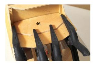
Nachdem der Klebstoff getrocknet ist, die Frontteile (43 + 44) anpassen und ankleben. Die seitlichen Frontteile (44) sind mit genügend Übermaß gefertigt, dass diese Teile gut angepasst werden können.
