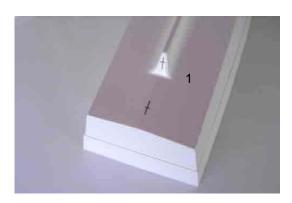
Jetzt bohren Sie die Löcher für das Stevenrohr und den Ruderkoker.
