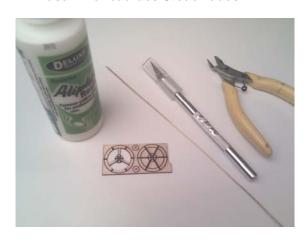
Für den Zusammenbau des Steuerrades benötigen Sie das Laserbrettchen, ca 12 cm Messingdraht 1 mm, sowie Weißleim oder Aliphatleim, ein Balsamesser, einen Seitenschneider und etwas Schleifpapier.
