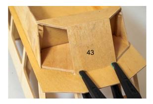
Jetzt die Aufdoppelungen 47 und 48 aus Reststücken Sperrholz 3 mm anfertigen und aufkleben.
