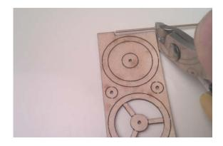
Mit Hilfe der Aussparung am Laserteil-Rand als Längenmaß schneiden Sie zunächst 6 gleiche Speichen vom Messingdraht 1 mm mit dem Seitenschneider ab.
