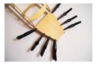
Wenn der Kleber getrocknet ist genau so mit der anderen Seite verfahren. Anschließend von innen kleben und mit Klammern sichern.
