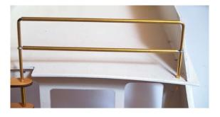
Den Griff des Leiterhandlaufes aus einem kurzen Stück Messingrohr 2 x 7 mm (104) ankleben.
