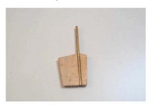
Kleben Sie mit Uhu Acrylit die Ruderachse ein und die zweite Außenseite (96 d) auf.
