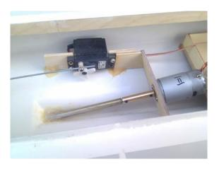
Mit UHU Plus Acrylit wird nun das Stevenrohr und der Motorspant im Rumpf eingeklebt und so vermufft, dass eine gute Verbindung und Abdichtung entsteht.
