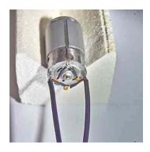
Nun kann der Antriebsmotor am Motorspant angeschraubt werden.
