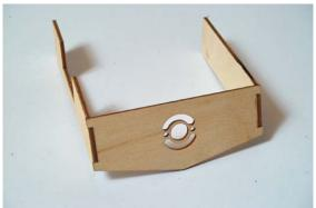
Als nächstes wird aus den Teilen 19, 20 und 21 die Fahrakkuhalterung und Empfängerbasis zusammengeklebt.
