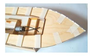
Das Deck punktuell mit dünnflüssigem Sekundenkleber fixieren. Danach die komplette Deckkante mit Sekundenkleber mittel verkleben. Die Verwendung von Aktivatorspray verbessert die Verklebung.
