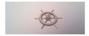
Befestigen Sie noch ein ca. 10 mm langes Stück Messingdraht in der Mittelbohrung und kleben Sie die zwei Distanzringe als Abstandhalter auf. Dann kann das Steuerrad nach Wunsch gebeizt und lackiert und am Steuerstand angeklebt werden.
