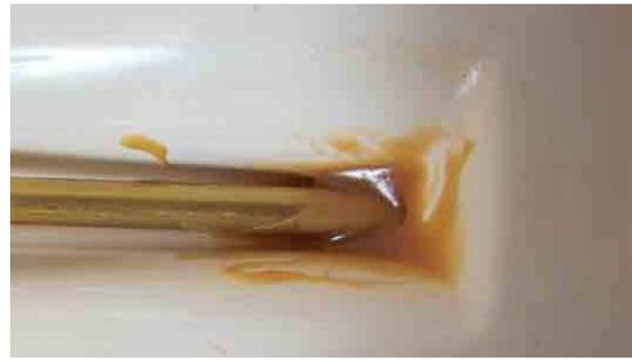
Wenn die Klebeverbindung am Stevenrohr getrocknet ist können der Ruderkoer und die Akkuhalterung im Rumpf platziert und mit UHU Plus Acrylit eingeklebt werden.
