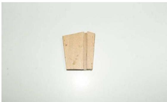
Dann werden die Innenteile auf eine Außenseite (160) des Ruders so geklebt, dass der Abstand für die Ruderachse entsteht.
