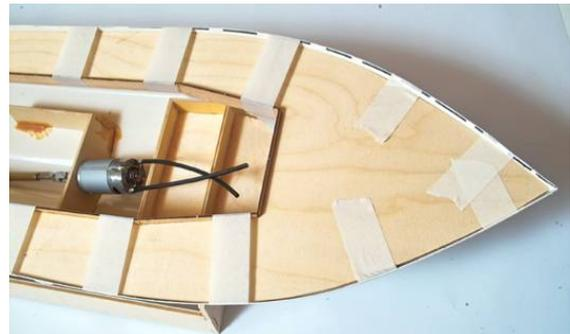
Das Deck punktuell mit dünnflüssigem Sekundenkleber fixieren. Danach die komplette Deckkante mit Sekundenkleber mittel verkleben. Die Verwendung von Aktivatorspray verbessert die Verklebung.
