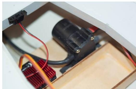
Den Ansaugschlauch und den Verbindungsschlauch zum Löschmonitor an die Pumpe anschließen.
