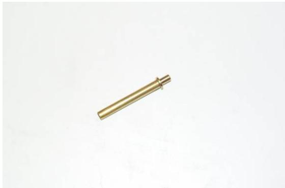
Düse 128 in Rohr 129 einpressen.
