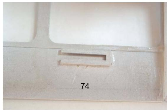
Den Motorträger mit Motor wieder ausbauen. Die Auflagen 74 im Anschluss komplett verkleben.
