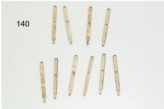
Die Relingstützen an den Laserkanten schleifen, damit später der Lack haftet. Die Stützen dann in die Aussparungen im Deck einsetzen aber noch nicht verkleben.
