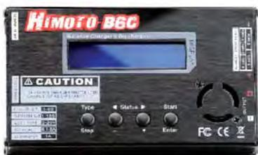
Wir empfehlen den HIMOTO B6C Computerlader Bestell-Nr. 79511 der direkt an einer 12 V Stromquelle (Autobatterie) angeschlossen werden kann. Ladestrom max. 5 A. Bis zu 6 Lipzellen können gleichzeitig geladen werden. Zum Lieferumfang gehören 6 verschiedene Ladekabel.
