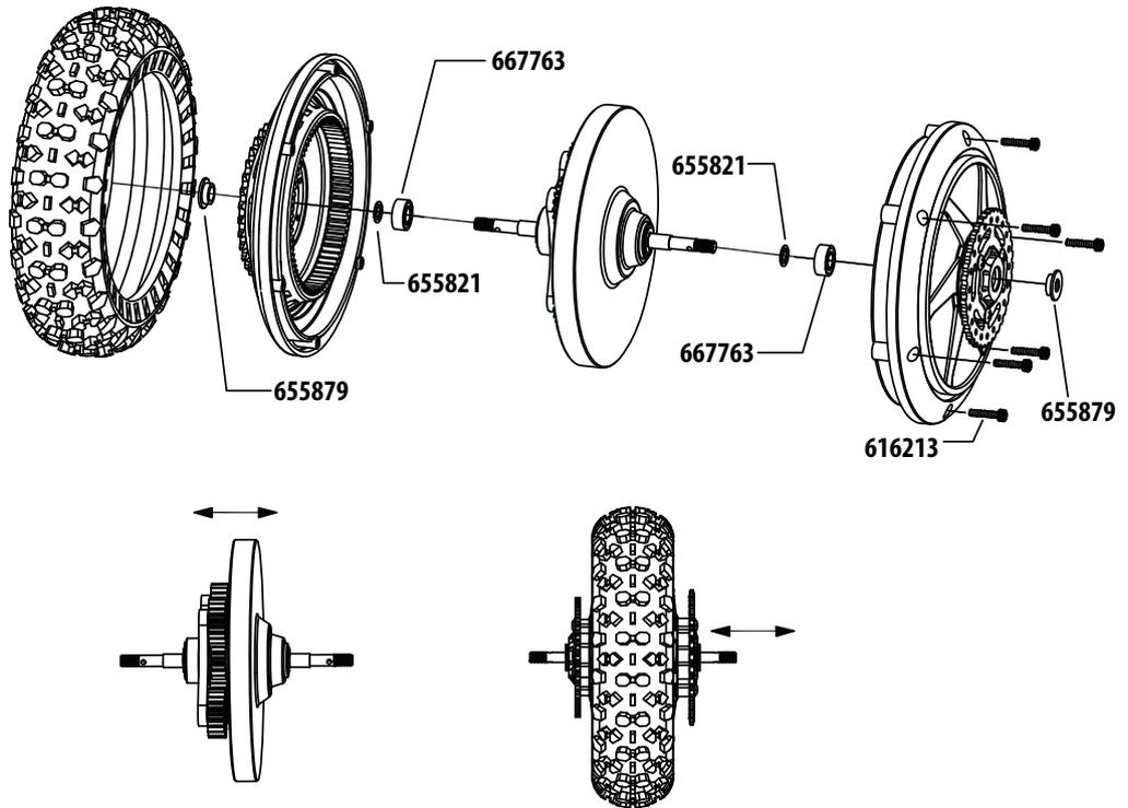
Wichtig: Zwischen der Gyroachse und dem Gehäuse ist nur minimal Axialspiel erlaubt. Um das Spiel der Achse zu justieren werden Schimscheiben Bestell-Mr. 655922 eingesetzt oder entfernt.
