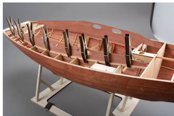
Vue : Insérez les flancs de cabine
