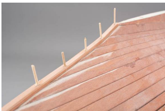
Vue : bouchage des trous de vis
