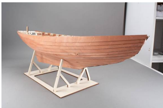
Vue : Coque coffrée
