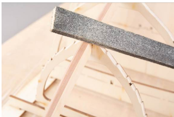
Abb.: Spanten straken
