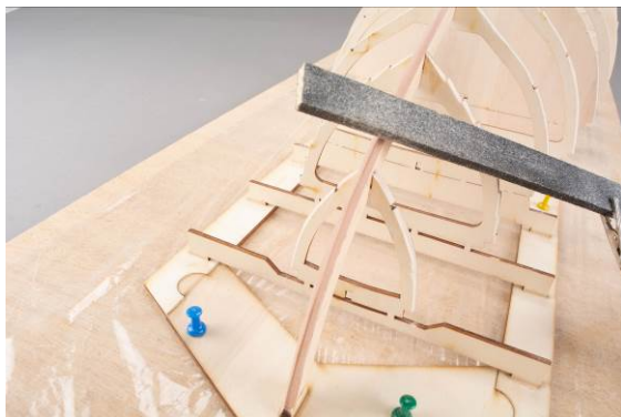
Abb.: Kieleisten und Spanten anschrägen – straken
