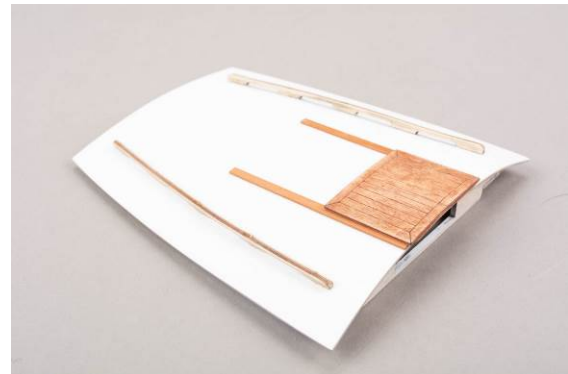
Abb.: Dach mit Schiebeluk und Handläufen
