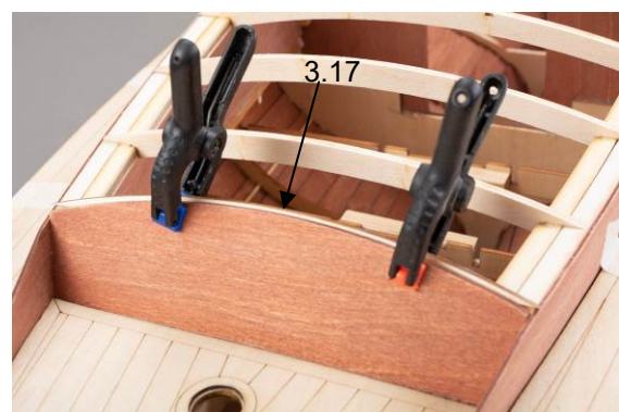
Abb.: Dachspant einkleben
