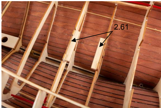
Vue : Support pour platine servo
