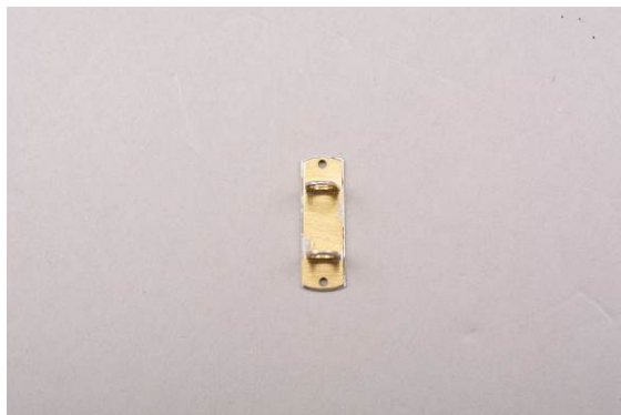
Abb.: Mastlager (gelötet)
