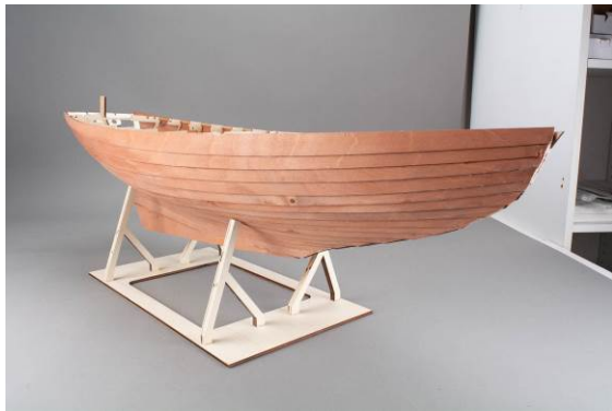
Abb.: Bepunkteter Rumpf Den Überstand der Planken am Heck plan- schleifen.
