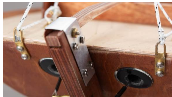
Abb.: Anbringung der Befestigungslaschen
