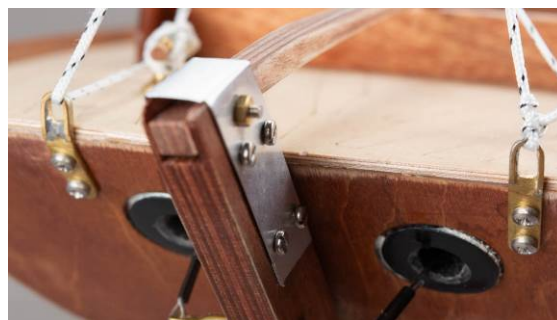
Vue : Montage des pattes de fixation
