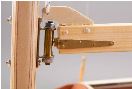
Abb.: Lümmelbeschlag komplett (wird erst später am Mast befestigt)
