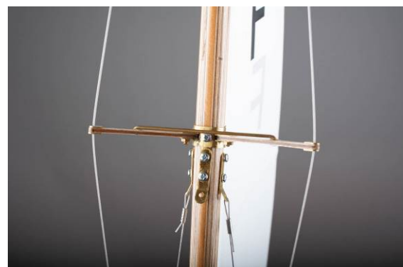
Abb.: Saling und Want bzw. Vorsegelaufhängung
