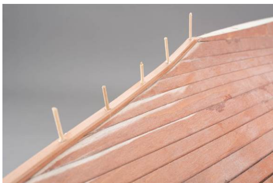
Abb.: Verschließen der Schraubenlöcher
