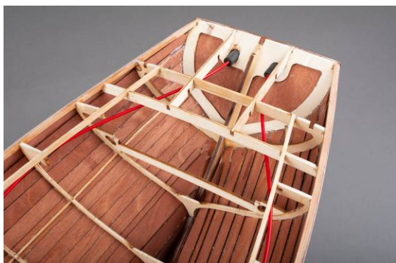
Vue : Gaines de commande
