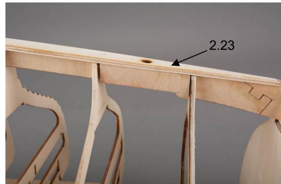
Abb.: Ausrichten und Aufkleben des Kielschweins, Kielbolzen vorne
