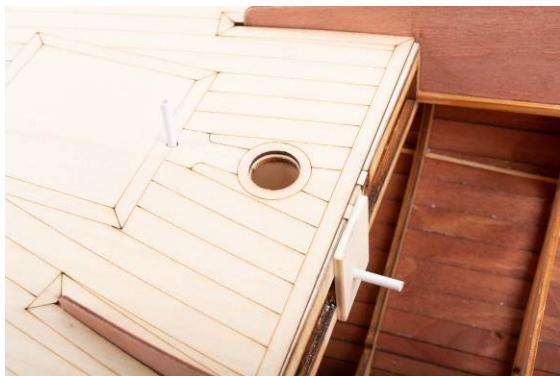
Abb.: Schotführung einkleben (hier im Prototyp mit extra Brettchen verbaut, nicht mehr nötig)
