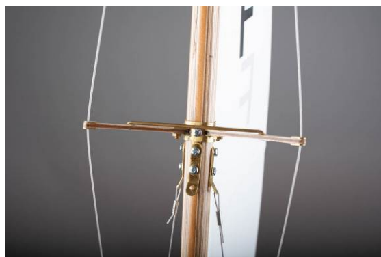
Vue : Barres de flèches et haubans, accrochage de voile avant
