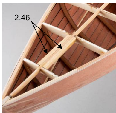
Abb.: Verstärkung Vorsegelbeschlag
