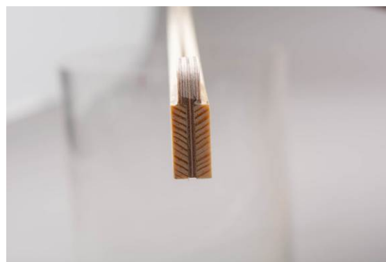
Vue : Positionnement des fibres
