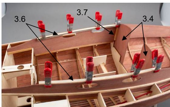
Vue : Paroi arrière Collez également les deux renforts de cabine 3.6.
