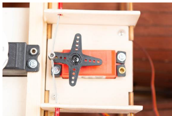
Vue : Fixation du servo
