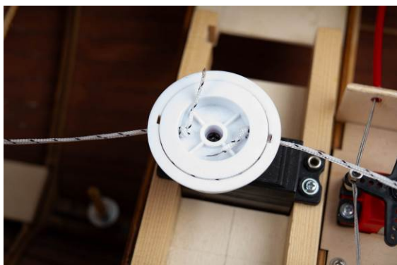
Vue : Treuil de voile monté
