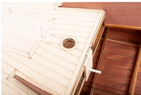
Vue : Guidage d'écoute collé (ici sur prototype avec une planchette non nécessaire)
