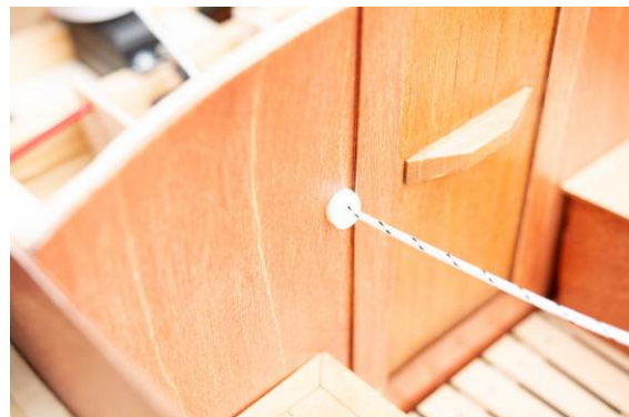
Abb.: Schotdurchführung Großschot
