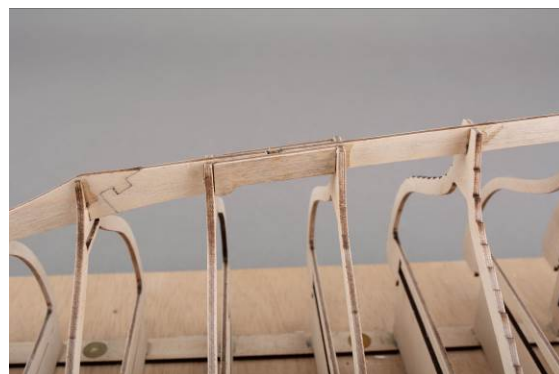
Vue : Renfort pour la fixation avant de quille
