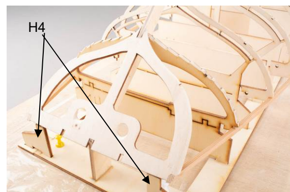
Abb.: Stützen Heckspiegel
