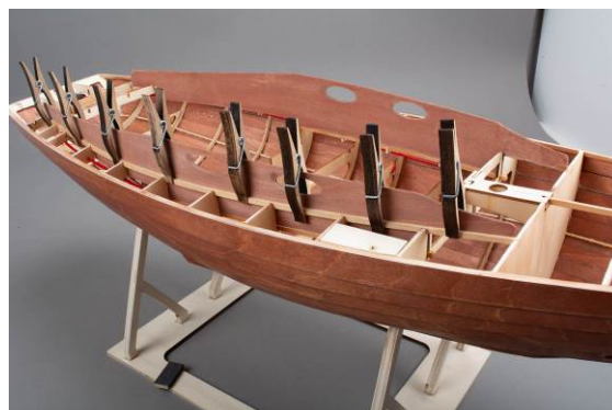
Abb.: Aufbauseiten einsetzen
