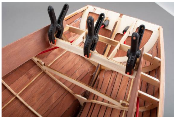
Abb.: Aufdopplung einkleben
