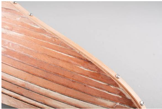
Abb.: Leisten aufgeklebt
