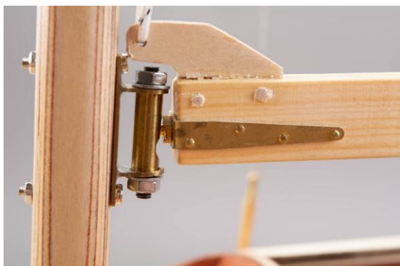
Vue : Vit de mulet complet (il sera monté plus tard sur le mât)
