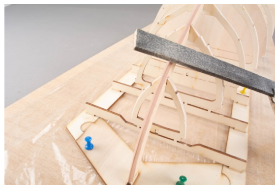
Vue : Chanfreinez les couples et les baguettes de quille – équerrage
