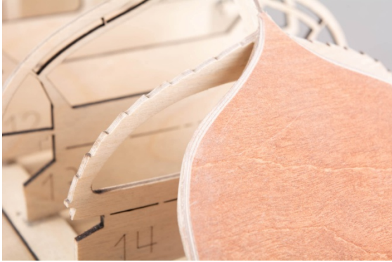
Fig.: Beveling the transom
