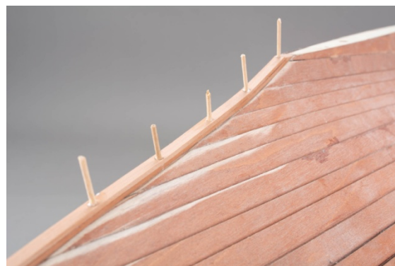
Vue : bouchage des trous de vis
