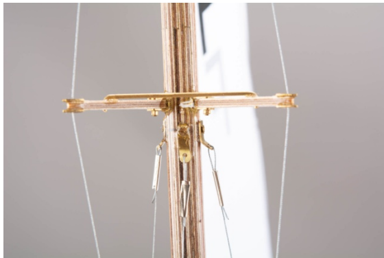
Abb.: Saling, Want und Vorsegelaufhängung
