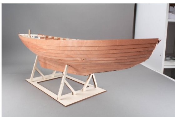
Vue : Coque coffrée
