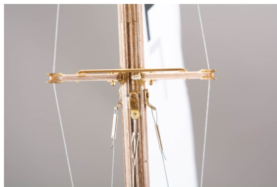
Vue : Barre de mât, galhaubans et accrochage de la voile avant
