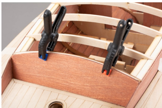
Abb.: Dachspant 3.17 einkleben
