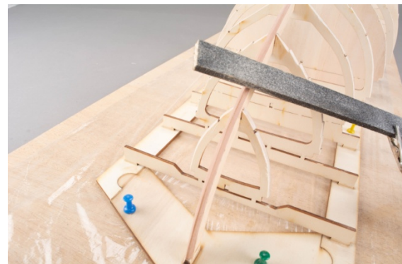
Abb.: Killeisten und Spanten anschrägen – straken
