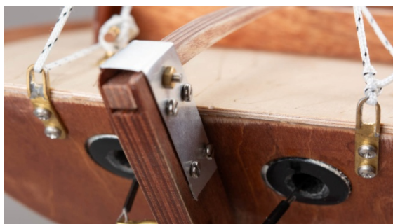
Vue : Montage des pattes de fixation (ici une vue de la grande version du modèle RC)
