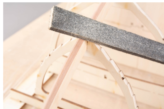
Abb.: Spanten straken
